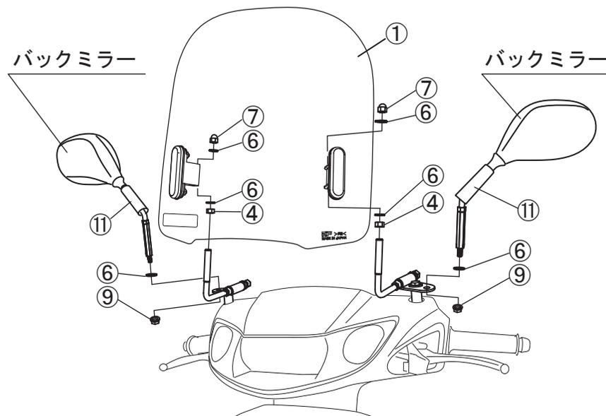
バックミラーを⑥プレーンワッシャー10mm、⑨フランジナット10mmを使い仮組みします。
